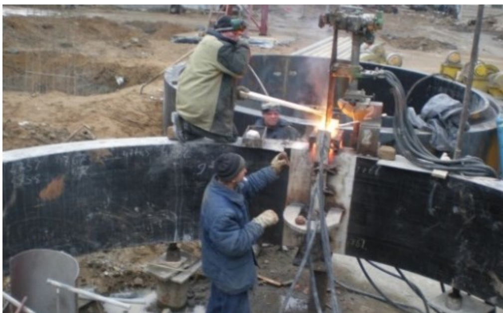
Рис. 3. Сборка полуколец бандажа [Щетинин Н. А. Процесс и оборудование для реконструкции бандажей вращающихся печей: диссертация ... кандидата технических наук: 05.02.13; [Место защиты: Белгородский государственный технологический университет им. В.Г. Шухова. Белгород, 2014. 204 с.]
